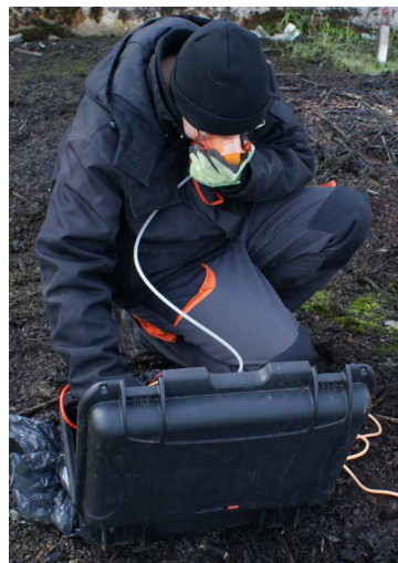
Oznaczanie stężenia zapachu olfaktometrem przenośnym Scentroid SM-100
