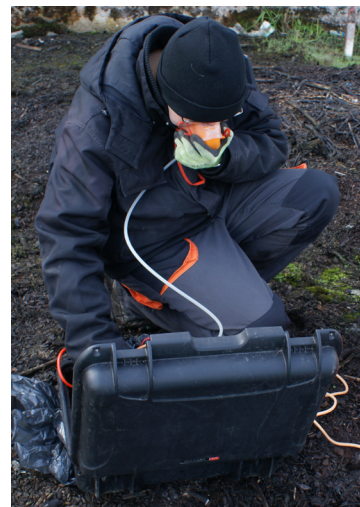
Oznaczanie stężenia zapachu olfaktometrem przenośnym Scentroid SM-100
