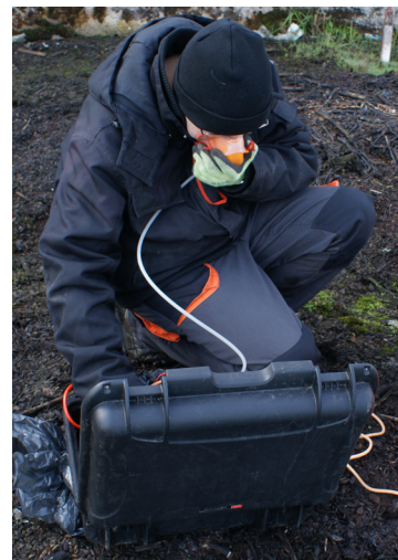
Oznaczanie stężenia zapachu olfaktometrem przenośnym Scentroid SM-100
